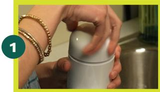
1 Desensrosque la parte superior de la unidad de filtración. Retire el filtro viejo.
